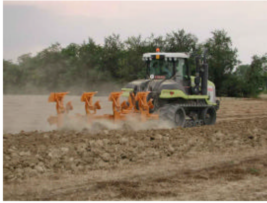
Figura 13: aratura con aratro polivomere
